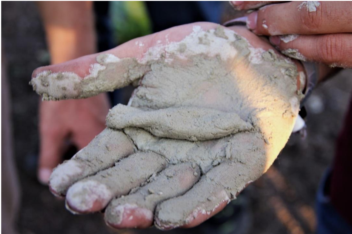
Abbildung 16: Bestimmung der Bodenart (Foto: Thomas Rupp)
